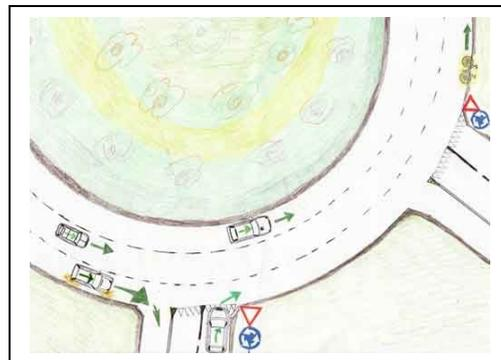
La **Rotatoria compatta** o piccola ha un diametro dai 32 ai 24 metri; presenta una sola corsia, a volte ne può avere 2; statisticamente pare la Rotatoria più sicura, ossia presenta come tipologia meno incidenti rispetto alle altre.
